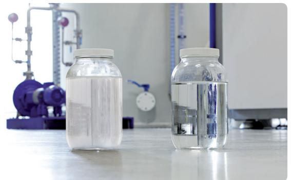
La comparaison à l'œil nu du distillat provenant d'un évaporateur sous vide traditionnel avec celui provenant d'un VACUDEST à avec l'option Clearcat montre que le stade de condensation avancé du Clearcat est une véritable avancée en terme de qualité des eaux usées traitées.
