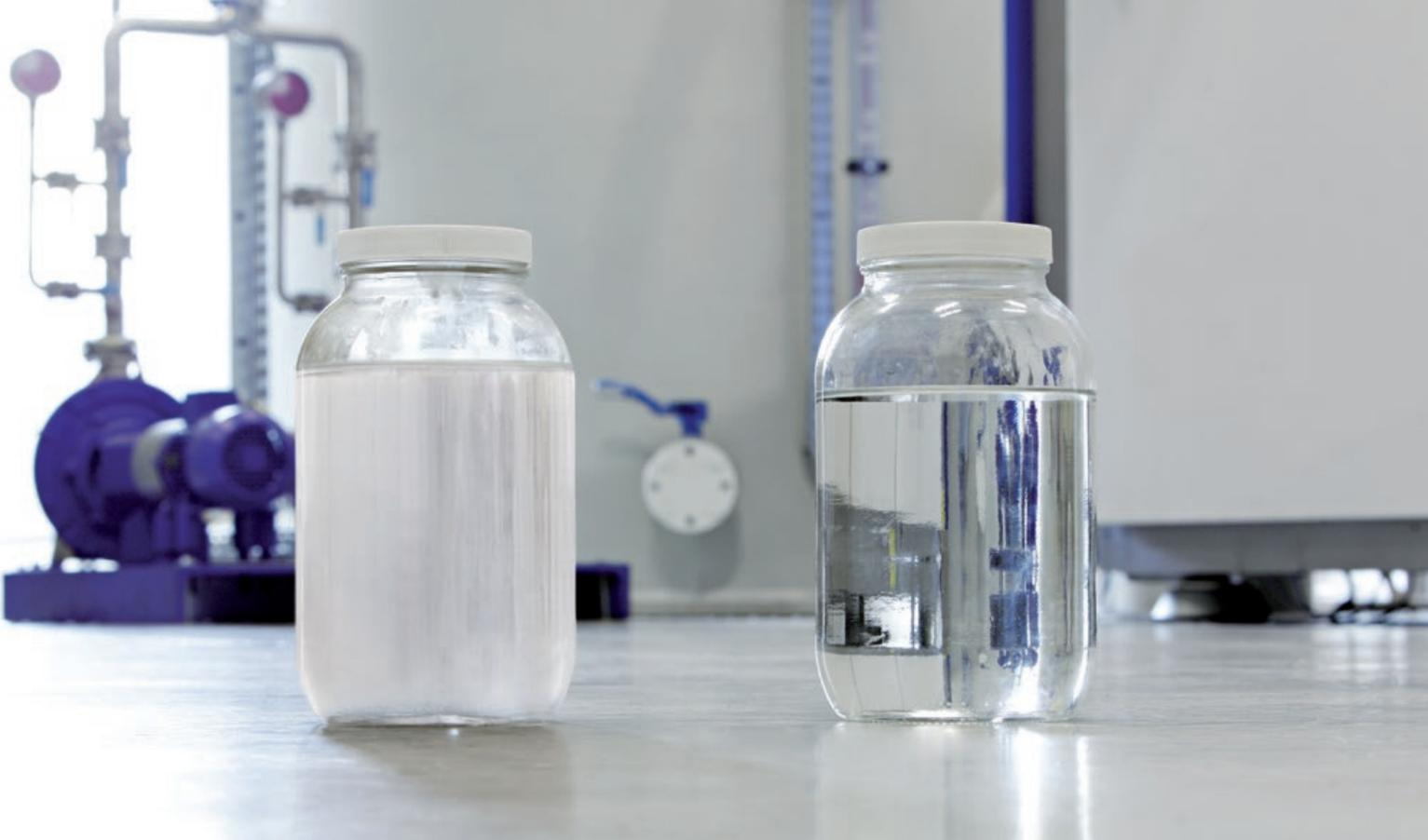
Der optische Vergleich von Destillat aus einem herkömmlichen Vakuumverdampfer mit dem Destillat aus einer VACUDEST Clearcat zeigt, dass die fortschrittliche Clearcat Kondensationsstufe Massstäbe hinsichtlich der Qualität des aufbereiteten Industrieabwassers setzt. Das Ergebnis ist glasklar und nahezu ölfrei.
