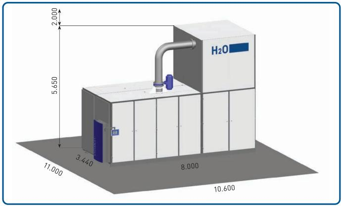
Dimensions des systèmes d'évaporation sous vide VACUDEST avec espace minimal prévu pour accéder à l'installation
